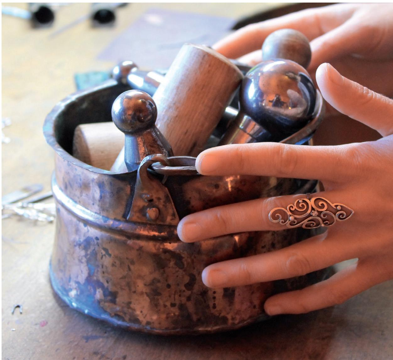
**BOUTEROLLE** – Outil à tête ronde, genre de poinçon qu'utilisent les orfèvres pour sertir et faire les chatons des bagues, et les graveurs en pierres fines pour travailler à la poudre d'émeri les camées et les intailles.
